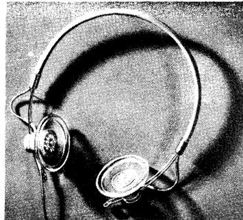
Bild 22. Dynamischer Stereo-Kopfhörer der AKG
