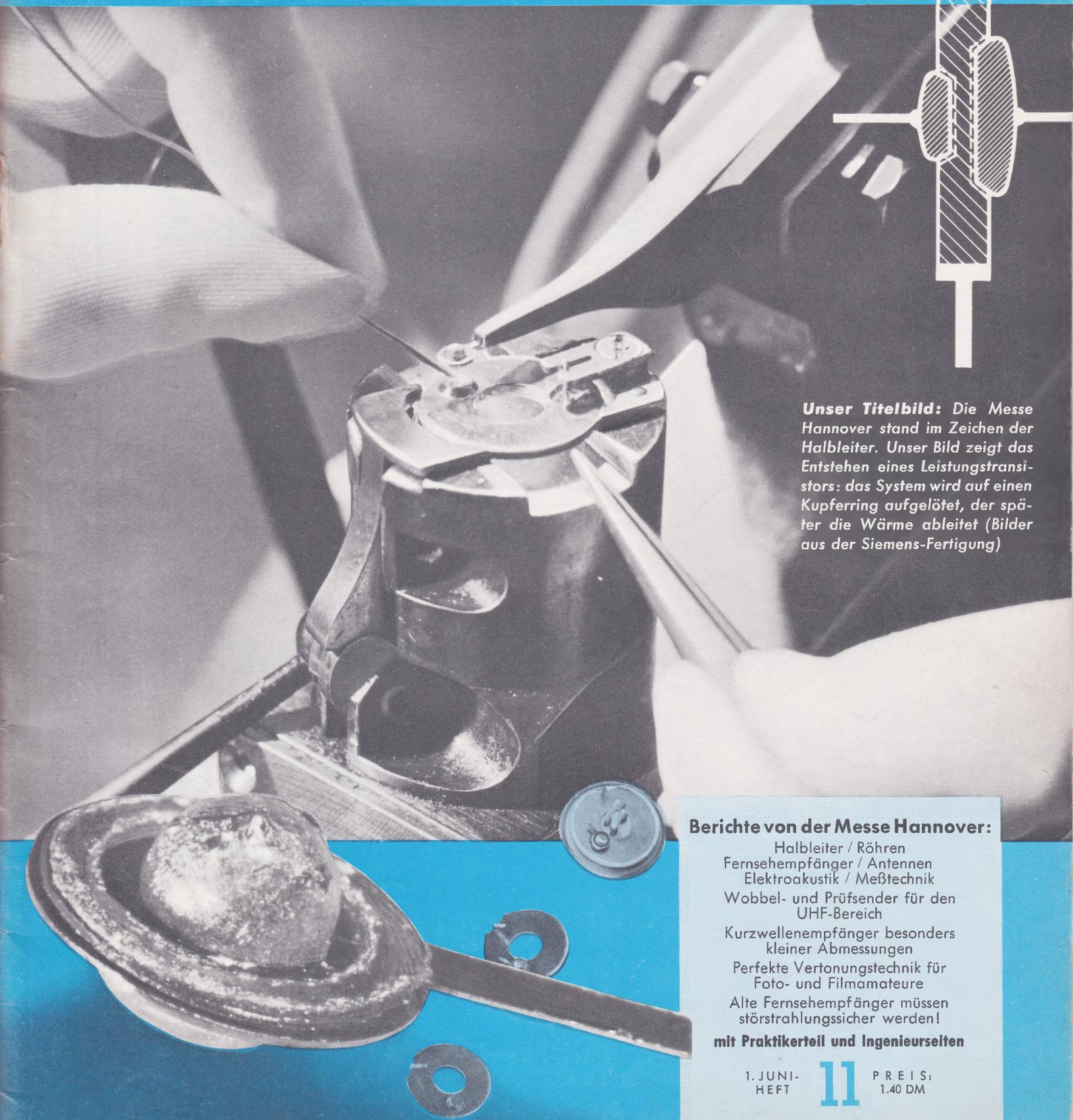
**Unser Titelbild:** Die Messe Hannover stand im Zeichen der Halbleiter. Unser Bild zeigt das Entstehen eines Leistungstransistors: das System wird auf einen Kupfering aufgelötet, der später die Wärme ableitet (Bilder aus der Siemens-Fertigung)
