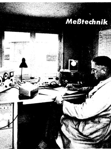
Bild 11. Meßkabine des Störstrahlungs-Meßplatzes
